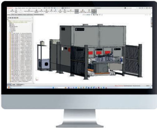
Robotik sistemin Magmaweld tarafında projelendirilmesi
