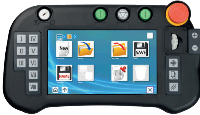
İş eldiveni ile de kullanılabilen dokunmatik ekran
